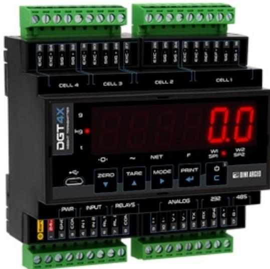
Trasmettitore di peso digitale progettato specificamente per l'uso con pesa a ponte digitale e silos. Integra le funzionalità di indirizzamento, sostituzione rapida, equalizzazione e calibrazione delle celle di carico.
